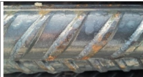
شکل 2 پوسته و حباب‌های سطحی میل‌گرد قطر ۲۲
