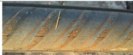
شکل ۵ ترک طولی میلگرد قطر ۳۲
