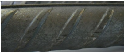
شکل ۶ ترک طولی میلگرد قطر ۳۲
