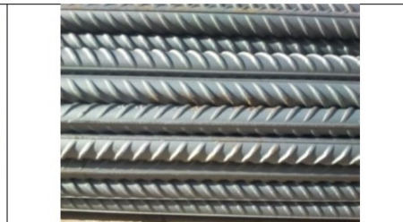
شکل ۱ نمونه‌ای از میل‌گرد قطر بدون عیب ظاهری با قطر کمتر از ۲۸
