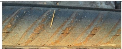
شکل ۵ ترک طولی میلگرد قطر ۳۲
