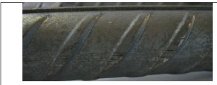
شکل ۶ ترک طولی میلگرد قطر ۳۲
