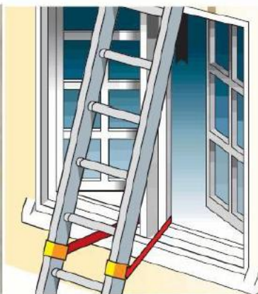
شکل ۸- نحوه تکیه‌گاه فوقانی نردبان یک طرفه
